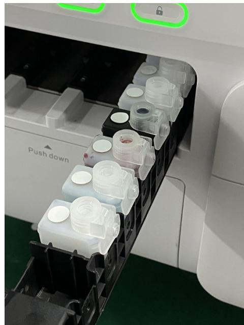
Figura 6-3 Destape la botella de reactivo y fíjelo entre las dos paredes laterales de sujeción.
