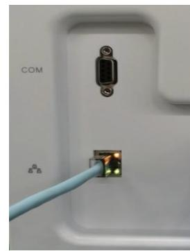
Figura 2-2 Conexão do Cabo de Dados
