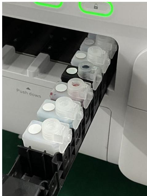
Figura 6-3 Desenroscar o frasco de reagente e fixá-lo entre duas paredes laterais de fixação
