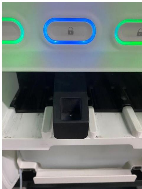
Figura 6-4 Instalar corretamente o suporte de reagentes
