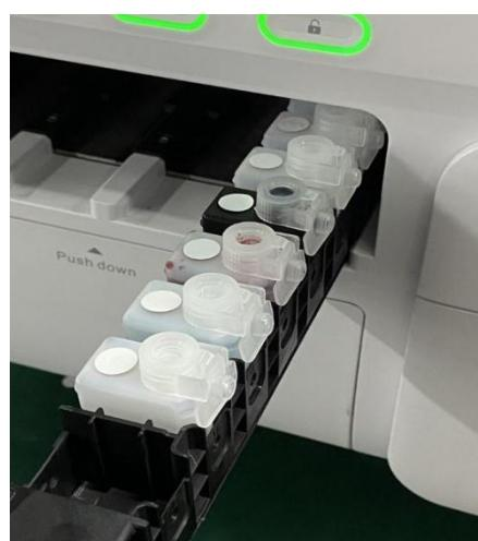
Figure 6-3 Retirez le bouchon du flacon de réactif et fixez-le entre les deux parois de maintien.
