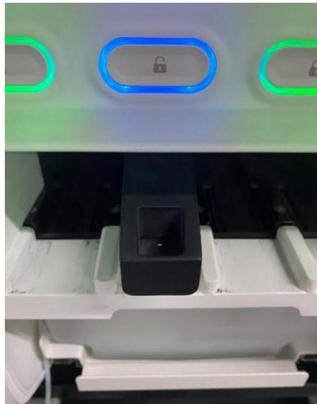
Figure 6-4 Installation correcte du portoir à réactifs
