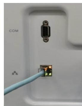
Figure 2-2 Connexion du câble de données
