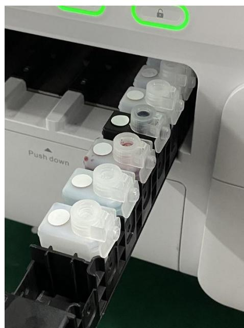
Abbildung 6-3 Entfernen Sie die Abdeckung der Reagenzflasche und befestigen Sie sie zwischen den beiden Klemmseitenwänden
