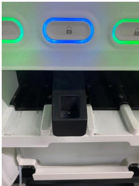
Abbildung 6-4 Korrektes Einsetzen des Reagenzgestells
